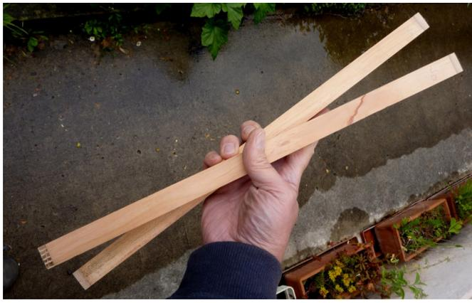
Plots carrés en abricotier. Pour être sûr d'avoir le même son pour chaque baguette, il faut faire sonner les plots. Si ils ne sonnent pas pareil, il faut fabriquer d'autres plots jusqu'à l'accord. Il y a alors un risque de poids différents. Un écart d'un demi ton ou d'un ton est peut être plus gênant qu'un écart de 1 ou 2 gr.
